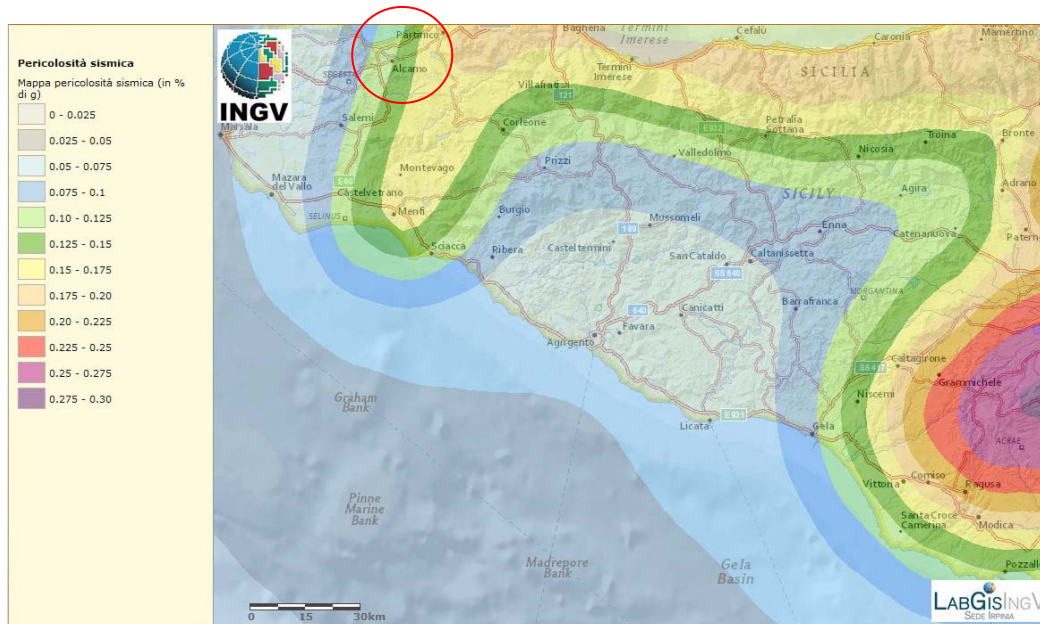
Figura 3.9 - Mappa della pericolosità sismica espressa in termini di PGA con probabilità di eccedenza del 10% in 50 anni riferita a suoli rigidi ( V_s > 800/m ), O.P.C.M. n. 3274 20/03/2003.
